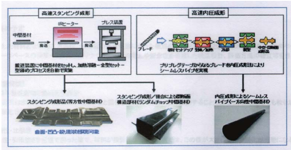
図 18 高速スタンピング技術と高速内圧成形技術 (12)
